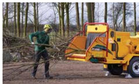
**SISTEMA BREVETTATO SMARTFEED.** Il sistema brevettato SmartFeed aiuta a incrementare la produttività dell'operatore, riducendo la sollecitazione sulle parti principali del motore. Il sistema di controllo, dotato di un sistema di rilevamento del materiale in entrata, monitora il numero di giri del motore (giri/min), arrestando e invertendo ai rulli quando si presentano materiali più larghi o più robusti.
