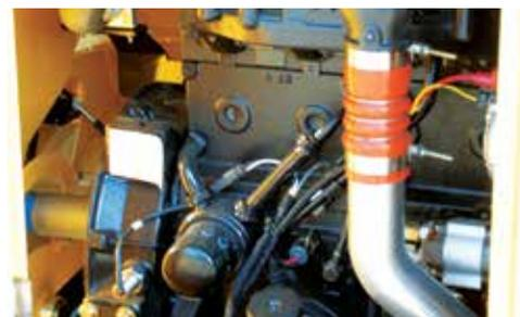
**PERFORMANCE POTENTE.** Il motore Deutz TD2.9L Tier 4 Final fornisce una potenza di 55 kW (74 hp), permettendo prestazioni eccellenti.
