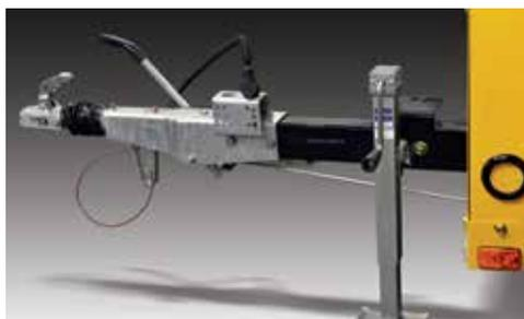
**ATTACCO EUROPEO E FRENO DI ACCOPPIAMENTO** Il carrello, che ha ottenuto la certificazione europea, è dotato di un asse Knott e di un freno di accoppiamento. Il carrello molto robusto consente una potenza di traino elevata sulla strada.
