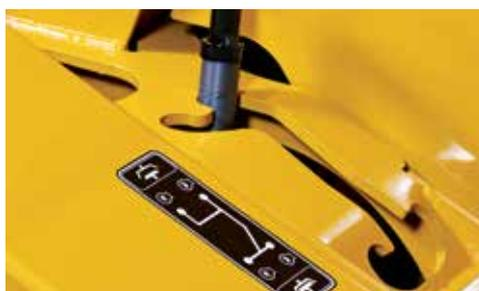
**SISTEMA PTO SENZA FRIZIONE.** Un sistema PTO (Power Take Off, a presa di forza) senza frizione permette di azionare il dispositivo di taglio senza utilizzare il tradizionale giunto a frizione o la puleggia folle e senza fare funzionare a vuoto il motore. La manutenzione del sistema è semplice: dopo aver alzato la protezione, è facile cambiare le cinghie senza utilizzare strumenti.
