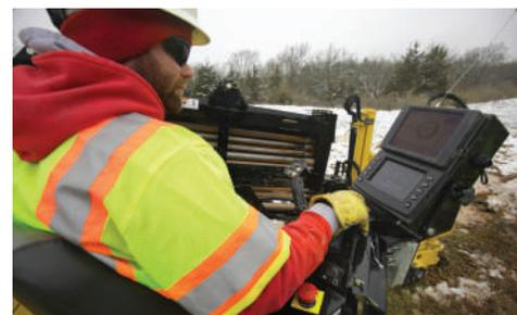
**PERFORAZIONE TRANQUILLA.** Seguendo le linee guida della gamma S3, il D23x30DR S3 produce un'emissione sonora pari a 83 dB(A) all'orecchio dell'operatore, ottimizzando quindi la comunicazione della squadra e creando un ambiente di lavoro tranquillo, che riduce il disturbo degli abitanti dei quartieri residenziali e delle aree urbane più densamente abitate.
