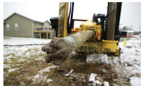
**ACCESSORI ROBUSTI.** Grazie alla curvatura a 2° posta nella parte anteriore, la nuova testa di perforazione RH10 ingrassabile permette una sterzata reattiva al comando di guida, per installazioni di precisione.
