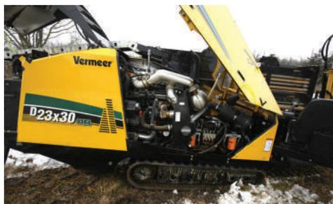
**POTENZA PREMIUM.** Il motore Deutz TCD3.6L da 100 hp (75 kW) garantisce la potenza necessaria che permette di operare con il D23x30DR S3 al massimo delle sue possibilità, mentre la forza di tiro/spinta di 106,8 kN (24.000 lb) combinata con una coppia di torsione di 4.067,5 Nm (3.000 ft-lb) permettono di completare il lavoro anche nel terreno più impegnativo.
