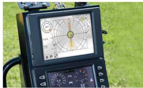
**DISPLAY TOUCH AURORA™.** Il display touch a colori interattivo fornisce dati in tempo reale facili da interpretare e localizzare nonché piani di perforazione, contribuendo ad incrementare la produttività.
