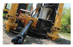
MENO RESTRIZIONI. Il design cavo dell'asta interna permette un flusso maggiore di aria e fluidi verso la testa di perforazione durante la realizzazione del foro pilota e dello scavo del foro in fase di tiro. Ciò permette all'operatore di scegliere tra diverse opzioni di attrezzatura, incluso martelli ad aria e alesatori più larghi.
