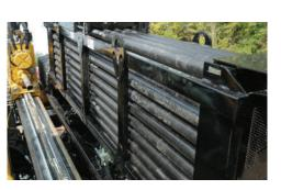
PIU' ASTE A BORDO. Installa più metri e risparmia tempo grazie alla capacità di ben 152,4 m (500') di carico aste a bordo.
