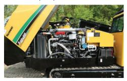
POTENZA IMPRESSIONANTE. Grazie ad un motore diesel John Deere da 140 hp (104 kW), questo perforatore lavora con una forza di tiro/spinta di 40.000 lb (177,9 kN) e una coppia di torsione di 7.457 Nm (5.500 ft-lb)
