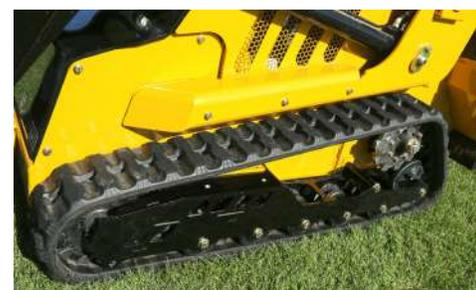
**ADATTA PER OGNI SFIDA.** Con una piastra per il montaggio degli accessori universale, una scelta tra cingoli da 17,8 o 22,8 cm e diverse opzioni motore, la S925TX è perfetta per aumentare la produttività in cantiere.
