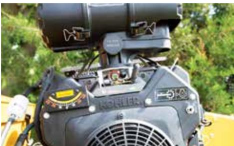
**AZIONAMENTO PIÙ SEMPLICE.** Dotata di un motore Kohler a iniezione elettronica (EFI) da 26,5 hp (19,8 kW), la SC292 si avvia bene anche con i climi più rigidi, dispone di un motore che si ingolfia raramente e ottimizza il risparmio di carburante rispetto ai motori a gas con carburatore comparabili.
