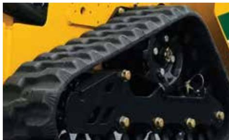
**I CINGOLI PIÙ LUNGI NELLA SUA CATEGORIA.** Garantisce una regolare stabilità e semplifica le operazioni di carico e scarico della macchina rispetto ai modelli con cingoli più corti. La maggiore lunghezza dei cingoli di questo modello, il migliore nel suo genere, fornisce una minore pressione sul terreno, che contribuisce a ridurre la possibilità di danni al manto erboso.
