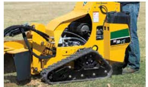
**DISCO DI TAGLIO A TRASMISSIONE IDRAULICA E AVANZAMENTO NEL TERRENO**
