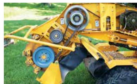
**FACILE MANUTENZIONE DELLE CINGHIE.** È possibile effettuare gli interventi di manutenzione alle cinghie del SC362 da un lato della macchina, mentre le cinghie della trasmissione del dispositivo di taglio sono regolabili mediante ingranaggi folli mobili. Inoltre, le impostazioni delle cinghie possono essere regolate indipendentemente l'una dall'altra, senza il bisogno di dover intervenire sulle altre cinghie.
