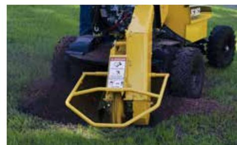
**SISTEMA DI CONTROLLO AUTOSWEEP®.** Opzionale. Il sistema AutoSweep monitora la velocità del motore e regola automaticamente la velocità di oscillazione del disco di taglio; è progettato per ridurre le sollecitazioni a motore, trasmissione e struttura.
