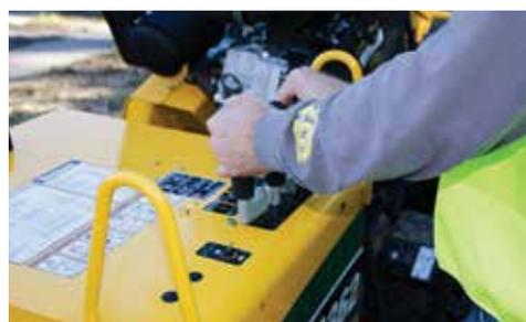
**SISTEMA DI RILEVAMENTO DI PRESENZA DELL'OPERATORE.** Le leve di controllo per l'oscillazione del braccio di sollevamento, per il suo innalzamento/abbassamento e per l'avanzamento della macchina sono state progettate con un sensore in grado di rilevare la presenza dell'operatore. Questo sistema di rilevamento di presenza semplice da usare è finalizzato a proteggere l'operatore e ad aumentare la sua sicurezza.
