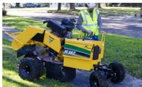
**AVANZAMENTO NEL TERRENO A DUE VELOCITÀ.** L'operatore può scegliere se lavorare impostando un intervallo alto o basso di velocità di avanzamento pari a 0-40,5 m/min per spostare la macchina velocemente oppure può scegliere un livello di velocità ancora più basso, per esempio in prossimità di un ceppo, impostando un intervallo di velocità basso pari a 0-20,1 m/min.
