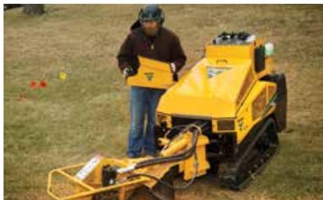
**SCEGLI LA VISUALE MIGLIORE.** La postazione laterale dell'operatore offre la possibilità di selezionare l'angolo migliore dal quale vedere la fresaceppi nel corso delle operazioni e fornisce tutti le funzioni di controllo del disco di taglio e dell'avanzamento nel terreno della macchina in avanti e all'indietro.
