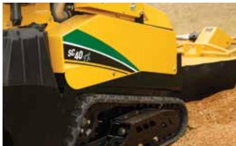
**SISTEMA ALL-TERRAIN.** Un carrello a cingoli controrotanti migliora la manovrabilità, semplificando il riposizionamento durante il taglio di un ceppo. I cingoli permettono una stabilità ottimale della macchina, dando la possibilità di lavorare anche in condizioni del terreno sfavorevoli.
