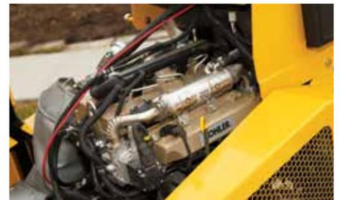
**MASSIMA POTENZA SUL CEPPO.** Un motore diesel T4 Final da 40 hp (29,8 kW) fornisce un'elevata potenza e utilizza un sistema di post-trattamento DOC (Diesel Oxidation Catalyst - Catalizzatore di ossidazione diesel), che permette di ridurre la manutenzione nonché i costi operativi.
