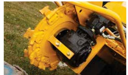
**PRODOTTI ALL'AVANGUARDIA.** Il disco di taglio è dotato della tecnologia proprietaria Vermeer Pow-R™, che aiuta a ridurre il rimbalzo durante il taglio, aumenta la protezione delle tasche dei denti di taglio e diminuisce la perdita di potenza dovuta al ricircolo di trucioli.
