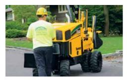
TRAZIONE INTEGRALE CON BLOCCAGGIO **DEL DIFFERENZIALE.** Grazie alla potenza e alle coppie trasferite a ognuna delle quattro ruote, la SC552 è in grado di operare in condizioni difficili e su terreni irregolari, dove l'operatore può attivare il bloccaggio del differenziale per mantenere la potenza di trazione durante percorsi irregolari delle ruote.
