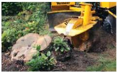
MASSIMA LARGHEZZA DI TAGLIO. La SC552 permette all'operatore di non perdere tempo a riposizionare la macchina, che offre un'altezza di taglio 78,7 cm sopra il terreno e di 63,5 cm sotto il terreno. La dimensione lineare del taglio consente all'operatore di tagliare ceppi di 1,8 m senza dover riposizionare la macchina.
