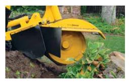
FUNZIONAMENTO REGOLARE. L'esclusivo SISTEMA DI CONTROLLO SmartSweep™ monitora il carico del motore e fornisce un feedback continuo che permette una più facile e costante velocità di oscillazione del disco di taglio.
