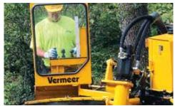
SISTEMA DI RILEVAMENTO DI PRESENZA **DELL'OPERATORE.** Questo sistema semplice da usare è finalizzato a proteggere l'operatore e ad aumentare la sua sicurezza. Se la/e mano/i dell'operatore abbandonano i comandi di controllo per più di un secondo, il disco di taglio di disattiva, si arresta e la luce dell'indicatore si spegne.
