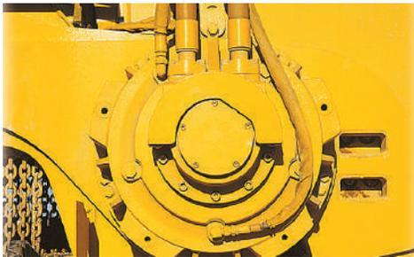
**DOPPIO MOTORE ROTARY POWER.** Due motori ad Rotary Power consentono una performance di taglio delle rocce a una bassa velocità e ad una coppia elevata, fornendo una maggiore penetrazione nel terreno e una minore usura della catena.
