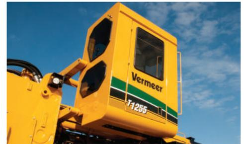
**CABINA CHIUSA SOPRAELEVATA.** La cabina sopraelevata offre una maggiore visuale e un comfort aggiuntivo grazie al sedile con sospensioni pneumatiche. La cabina chiusa dispone di un sistema autonomo di riscaldamento e raffreddamento e di schiuma insonorizzante. È inoltre una struttura dotata di moduli di protezione in caso di ribaltamento e contro la caduta di oggetti.
