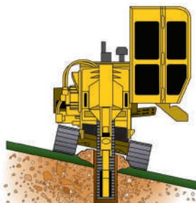
**CINGOLI AUTO-INCLINANTI OPZIONALI.** Una struttura oscillante dei cingoli permette loro di seguire la linea del terreno, permettendo uno scavo verticale con pendenze fino a 10 gradi.
