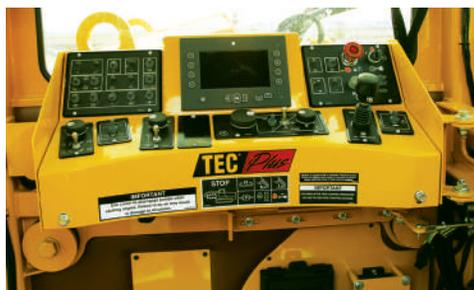
**SISTEMA ELETTRONICO DI CONTROLLO TEC® PLUS.** Il sistema operativo comunica con moduli di controllo multipli posizionati su tutta la macchina, consentendo la raccolta in tempo reale dei dati sul suo rendimento e capacità di risoluzione guasti avanzate.
