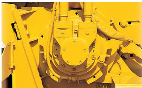
**MOTORE ROTARY POWER.** Un motore di comando del trencher Rotary Power e un albero con millerighe producono una velocità più bassa e una coppia più alta, fornendo quindi una maggiore penetrazione nel terreno e una minore usura della catena per ottenere migliori risultati di produzione.
