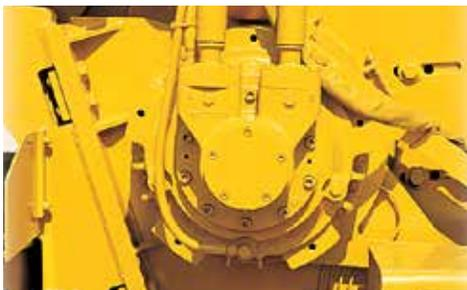
**MOTORE DI COMANDO DEL TRENCHER ROTARY POWER.** Un motore di comando del trencher Rotary Power e un albero di millerighe producono una velocità più bassa e una coppia più alta, fornendo quindi una maggiore penetrazione nel terreno e una minore usura della catena per ottenere migliori risultati di produzione.
