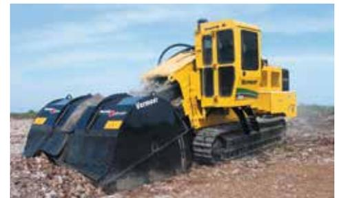
**ACCESSORIO SCAVATRICE DA SUPERFICIE TERRAIN LEVELER®.** Il T855III ha un'opzione per il Terrain Leveler con trasmissione a catena, adatta ad applicazioni relative a scavi di grandi rocce incluse l'estrazione in superficie, la rimozione del terreno di copertura, la preparazione del sito dei lavori e la demolizione di strade.
