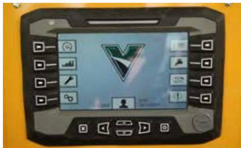
**SISTEMA ELETTRONICO DI CONTROLLO SMARTTEC.** Il software di prestazioni SmartTEC aiuta ad ottimizzare la produttività grazie a messaggi di controllo della macchina in tempo reale. Le funzioni di monitoraggio e rilevamento incoraggiano la manutenzione proattiva della macchina e l'analisi delle prestazioni dell'operatore. Disponibile su tutti i Vermeer Macchine dotate di TEC® Plus
