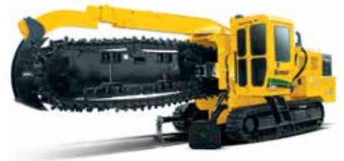
**CABINA CHIUSA SOPRAELEVATA.** La cabina sopraelevata offre una maggiore visuale e un comfort aggiuntivo grazie al sedile con sospensioni pneumatiche. La cabina chiusa dispone di un sistema autonomo di riscaldamento e raffreddamento e di schiuma insonorizzante. È inoltre una struttura dotata di moduli di protezione in caso di ribaltamento.
