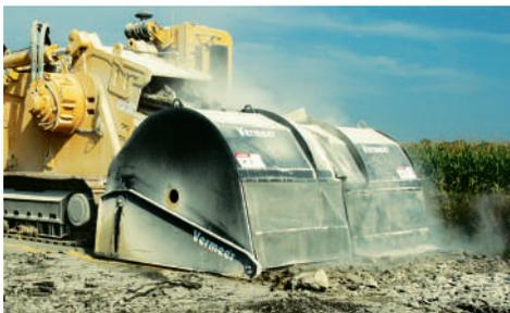
**ACCESSORIO SCAVATRICE DA SUPERFICIE TERRAIN LEVELER®.** Il T955III ha un'opzione per il Terrain Leveler con trasmissione a catena, adatta ad applicazioni relative a scavi di grandi rocce incluse l'estrazione in superficie, la rimozione del terreno di copertura, la preparazione del sito di lavoro e la demolizione di strade.
