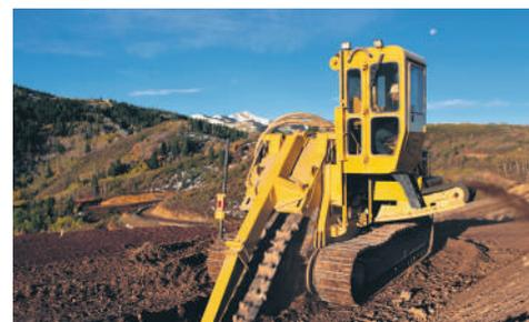
**CABINA ROPM SOPRAELEVATA.** La cabina sopraelevata con modulo di protezione dal ribaltamento trasversale (RPM, RollOver Protective Module) è dotata di vetri LEXAN®, aria filtrata e pressurizzata, riscaldamento e aria condizionata. La posizione privilegiata della cabina permette una visuale virtualmente illimitata del braccio, dello scavo e del nastro trasportatore.
