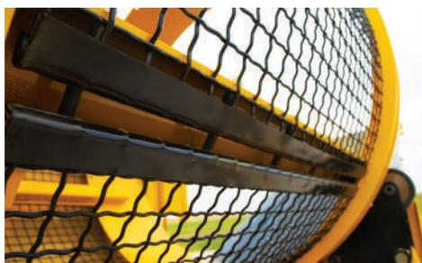
**VARIETA' DI PRODOTTI.** Cambia le dimensioni del prodotto in modo ancora più efficiente grazie al design a sostituzione rapida delle griglie. Cinque bulloni larghi regolano un gancio di tensione, per permettere agli operatori di cambiare velocemente la dimensione delle griglie.
