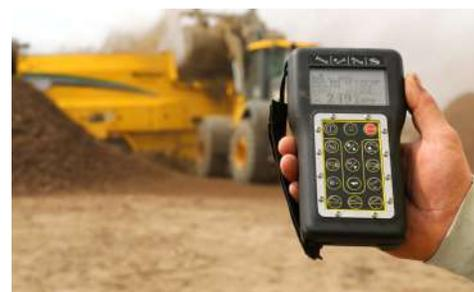
**SISTEMA DI CONTROLLO.** Gli operatori possono azionare la macchina sia con display DP10 Vermeer montato sul pannello di controllo, che tramite un telecomando manuale remoto. In entrambi i casi, l'operatore può scegliere tra quattro impostazioni programmabili o regolare manualmente il lavoro, in base al materiale in entrata.
