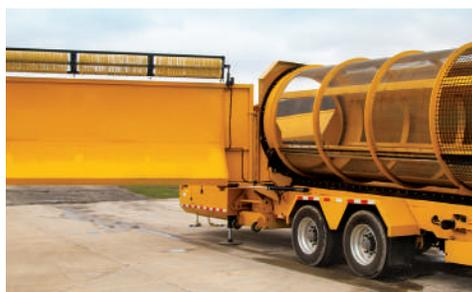
**ACCESSO SEMPLICE AL TAMBURO PER LA MANUTENZIONE.** Un pannello laterale a cerniera singola espone la piena lunghezza del tamburo del vaglio dal livello del terreno per l'assistenza del tamburo e la sua rimozione.
