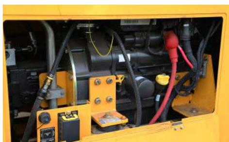
**MOTORE.** Il vaglio TR6400 è equipaggiato con motore Deutz 3.6L Tier 4F da Repetition 100 hp (75 kW), montato su un telaio a perno che ruota di 30 gradi, per un migliore accesso ai filtri del carburante ed al serbatoio idraulico per la manutenzione e l'assistenza.
