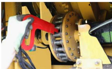
**GUIDA DEL TAMBURO.** Un sistema di guida idraulico della catena per mette la fuoriuscita del tamburo dalla sua sede per agevolare la manutenzione. I bulloni di serraggio dei pignoni possono essere sostituiti rapidamente, contribuendo a ridurre i costi di riparazione.
